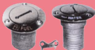
Tankeinfüllstutzen Niro AISI 316 A4 versenkbarer Griff; gerade Sicherungskette für den Deckel. Der Deckel überlappt den eigentlichen Tankstutzen, so daß im Deckel stehendes Wasser beim Öffnen nicht in den Tank läuft
