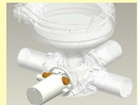
Sie können die Elektropumpe in vier verschiedenen Positionen einbauen immer im Zusammenhang mit dem Becken
